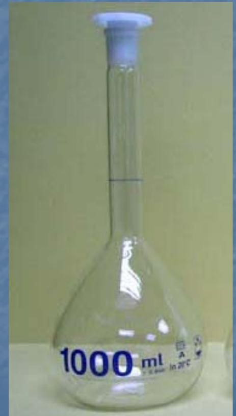
校正方法：秤量容器內所裝液體重量，利用已知液體密度求出容器內液體體積。
